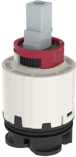
HANSA cartuccia 3.5 Classic; dischi ceramici con depositi di grasso integrati, protezione antiscottature regolabile ;limitatore di portata regolabile fino a ca. 6 l / min
